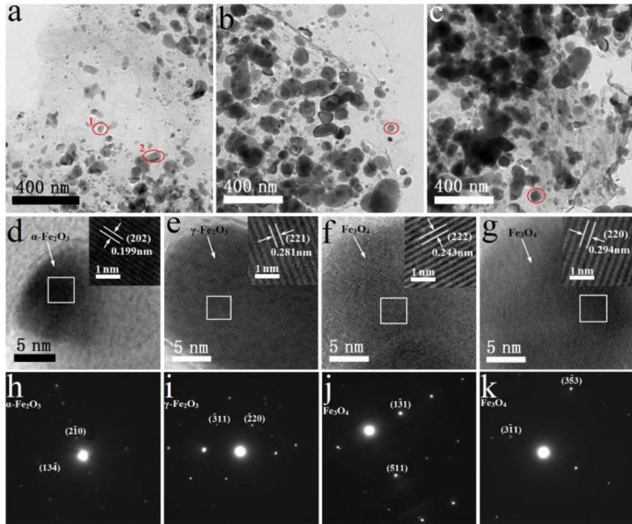
Fig. 12. Microscopy of  $\text{FeSO}_4 \cdot 7\text{H}_2\text{O} / \text{rGO}$  (Zhang, L. ; Yu, X. ; Hu, H. ; Li, Y. ; Wu, M. ; Wang, Z. ; Chen, C. 2015)
