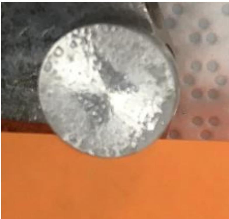
Prélèvement de deux gouttes à la pipette d'un fond de flacon Moderna. Ajout de trois gouttes d'éthanol pour disperser la suspension sur plot aluminium. Séchage. Pas de métallisation.
