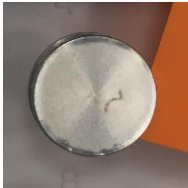
Prélèvement d'une goutte à la pipette d'un fond de flacon Pfizer. Ajout de trois gouttes d'éthanol pour disperser la suspension sur plot aluminium. Séchage. Pas de métallisation.
